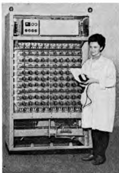
6-2. ábra. A KVF-2080/1440 típusú főegyenirányító, leemelt első borítólemezekkel
