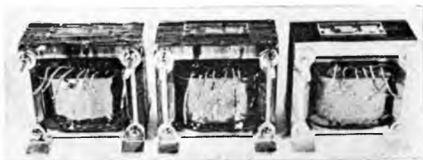
18-4. ábra. A transzformátorok a nedves-meleg igénybevétel után
