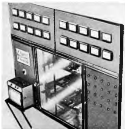
1-5. ábra. A tartampróbák végzésére szolgáló klímakamra homlokfala
